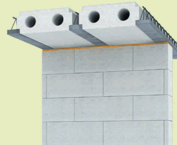
Połączenie ścianki działowej z PSM z prostopadłą ścianą konstrukcyjną zewnętrzną
