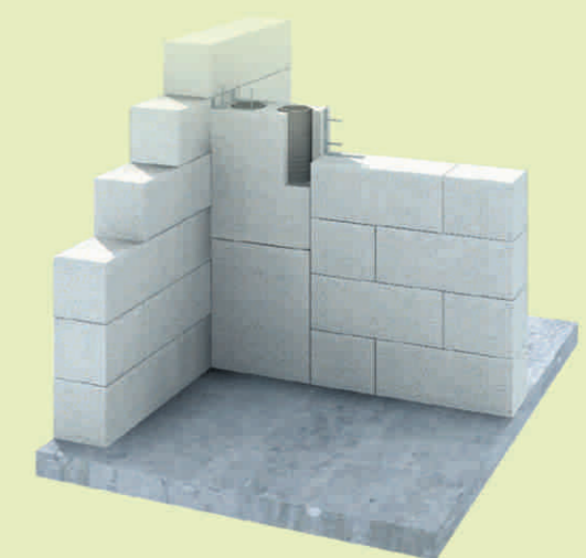
Elementy osłonowe instalacji wentylacyjnej
