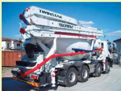
Betonomieszarka o pojemności 9m 3 z pompą o wysięgu 28m
